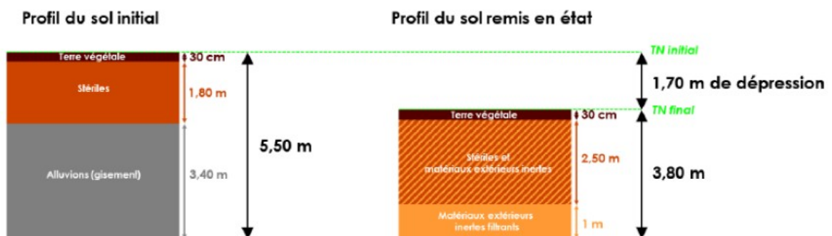
Figure 7 – coupe de remblaiement de l'excavation
